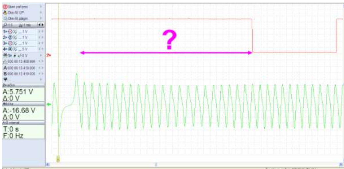
Obr. 8 Detail špatně nastaveného rozvodu našeho vozidla.
